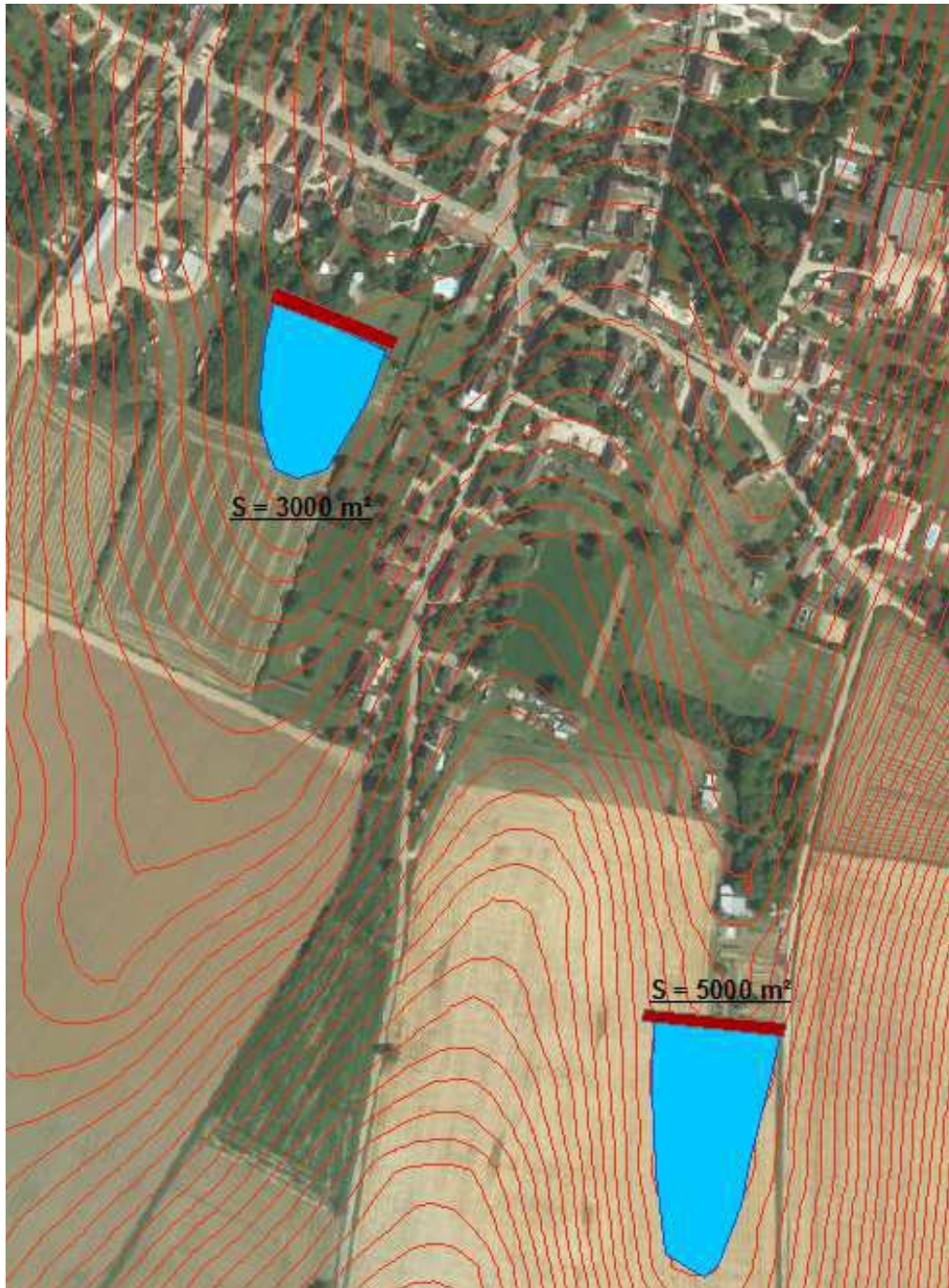
Figure 32 : Principe de l'aménagement des digues – BIOS 2014
